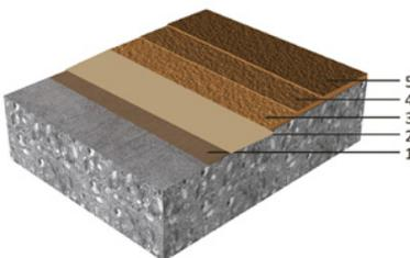
**Système Sikalastic® Pronto RB-5700 PUMA (~ 3 – 5 mm) (1/8 – 13/64 po) / Application sur rampes et pentes**
