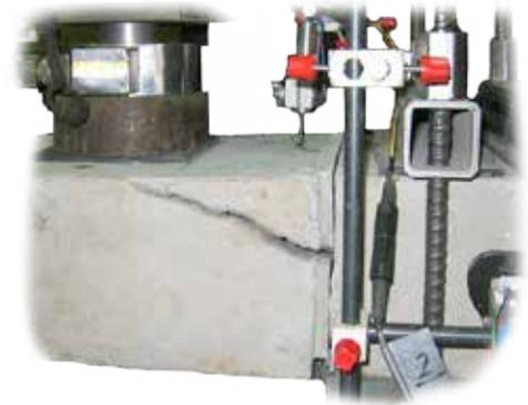
Défaillance typique du béton par « soulèvement » lors des tests sur les systèmes de goujonnage
