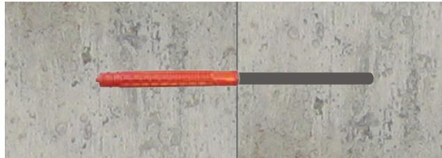
“Les joints dotés de dispositifs de transfert de charge sont recommandés dans les zones exposées à la circulation de véhicules ou au passage de charges lourdes. Lorsqu'un transfert positif est requis, des mesures doivent être prises afin de préserver l'alignement des dispositifs de transfert de charge au niveau des coffrages, et ce, pendant la construction et les opérations de finition du béton.”
