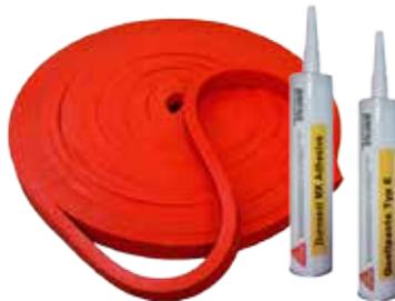
**SikaSwell®-A** (anc. Duroseal Gasket) est un profilé dilatable pour étanchéité active. Idéal pour les joints de construction, il se dilate au contact de l'eau pour former un joint de compression. SikaSwell®-A est un produit à base de résines acryliques. Disponible en trois modèles, il peut être collé sur différents types de substrat avec les adhésifs **Sika® MK Adhesive** ou **Quellpaste Type E**.
