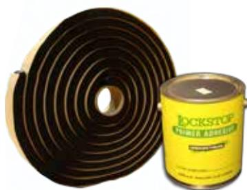
**Lockstop** est un mastic d'étanchéité, monocomposants et autoscellant, adhérent au béton pour empêcher le passage de l'humidité par les joints de construction. Il devra être utilisé en conjonction avec l'apprêt **Lockstop Primer Adhesive** afin de réaliser un liaisonnement étanche.
