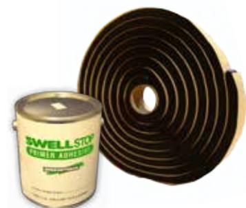
**Sika® Swellstop®** est un composé d'étanchéité hydrophile et flexible à base de caoutchouc butyle/argile expansif. Au contact de l'eau, le profilé va prendre de l'expansion pour former un joint de compression dans les joints de construction. Swellstop est disponible en deux dimensions et doit être utilisé avec l'apprêt **Swellstop Primer Adhesive** afin de créer un liaisonnement étanche.
