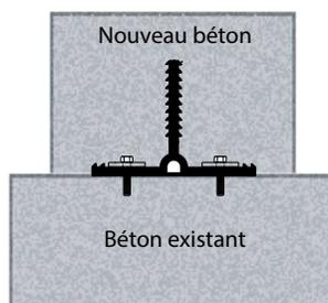
**Bande d'arrêt d'eau pour travaux de remise à niveau**, ce type de bande permet de réaliser une étanchéité optimale à la jonction d'une structure neuve et d'une existante. Il convient également à des joints présentant du mouvement. Ce système est composé de barres de positionnement en acier inoxydable et de fixations pour l'ancrage à la structure existante, en combinaison avec un gel époxy.
