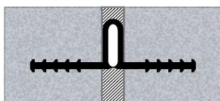
**Nervuré avec zone de déchirement,** ce profil permet d'accompagner des mouvements de joints plus importants. Lorsque le mouvement a lieu, le diaphragme de la zone de déchirement se rompt et autorise le mouvement au niveau du bulbe en forme de U, sans toutefois mettre le matériau en tension.
