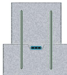
**Bandes d'arrêt d'eau sous forme de profilés adhérents**, ces derniers s'appliquent dans l'axe du joint ou au niveau des pénétrations de tuyaux, puis sont noyés dans le béton. Hydrotite est un arrêt d'eau hydrophile expansif en caoutchouc chloroprène formant un joint en compression lorsqu'il se trouve au contact de l'humidité. Pour des applications moins critiques, Sika offre les profilés expansifs SikaSwell®-A et Sika® Swellstop®.
