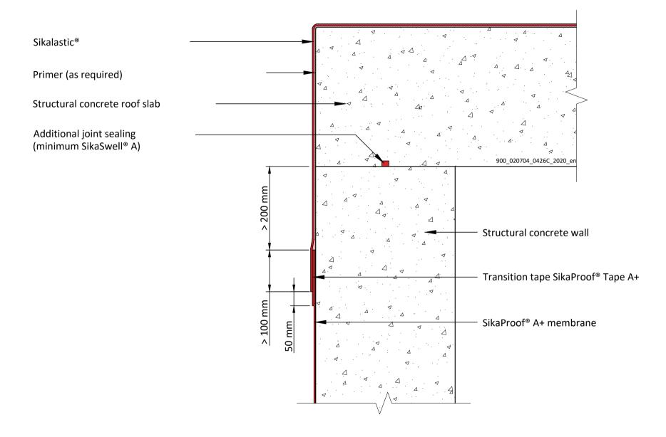
SikaProof® A+ TRANSITION WALL TO ROOF SLAB
