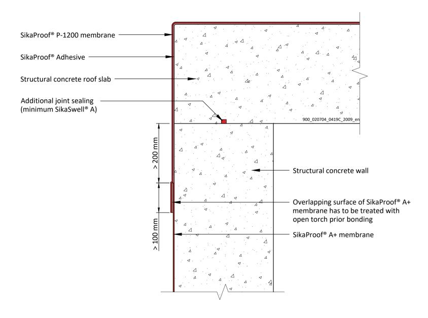
SikaProof® A+ TRANSITION WALL TO ROOF SLAB
