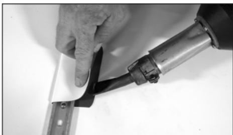
*Soudure d'un coussinet de protection*
