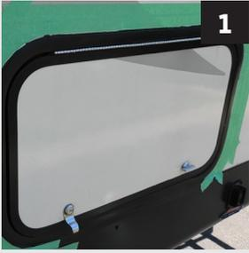
1 Afin de faciliter l'application, lorsque l'apprêt est appliqué, nous suggérons de délimiter la zone d'application à l'aide d'un ruban-cache adhésif afin d'éviter les débordements de mastic sur les vitres ou la peinture<sup>1</sup>.
