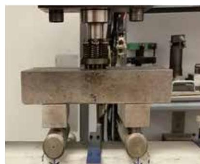
Poutre : ASTM C1609
