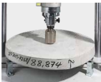
Éprouvette ronde : ASTM C1550
