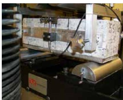
Poutre : ASTM C1399
