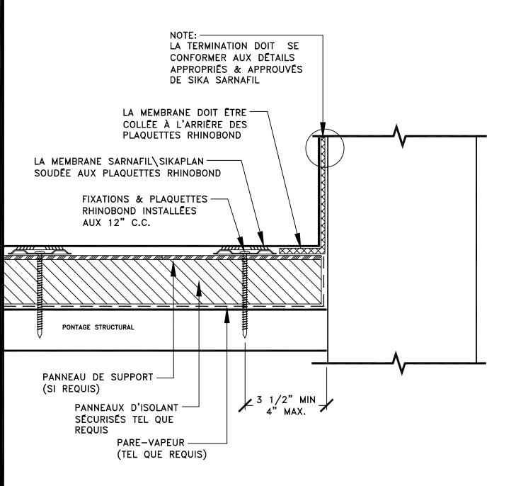
NOTE: NE PAS INSTALLER LES PLAQUETTES RHINOBOND TROP PRÈS DU MUR/PARAPET, PUISQUE LA SOUDEUSE RHINOBOND EST 7" DE LARGE ET DOIT ÊTRE CENTRÉE AUX DESSUS DES PLAQUETTES RHINOBOND POUR OBTENIR UNE SOUDURE OPTIMALE.
