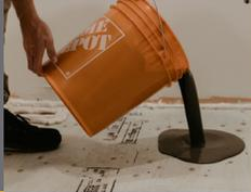
Sika® Level-125<sup>CA</sup> se coule et se place au racloir ajustable ou à la truelle à des épaisseurs allant de 1 à 38 mm. Débuller et éliminer les traces de truelle ou les variations d'application avec un rouleau débulleur en travaillant dans les deux directions (90°), pendant que la sous-finition est encore fraîche et fluide.
