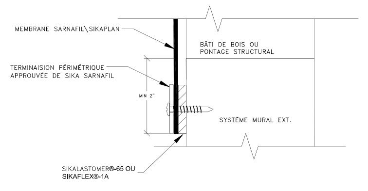
L'ÉTANCHÉITÉ À L'AIR DU REBORD PÉRIMÉTRIQUE EST EXIGÉE LORSQUE LE PARE-AIR N'EST PAS CONTINU AVEC LA MEMBRANE DE SOLIN.
