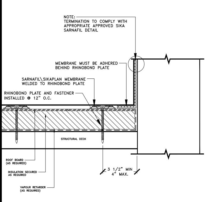
NOTE: DO NOT INSTALL RHINOBOND PLATES TIGHT AGAINST WALL. THE RHINOBOND WELDER IS 7" WIDE AND MUST BE CENTERED OVER THE RHINOBOND PLATE FOR PROPER WELDING
