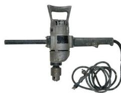
Perceuse électrique à basse vitesse (300 à 450 tr/min)
