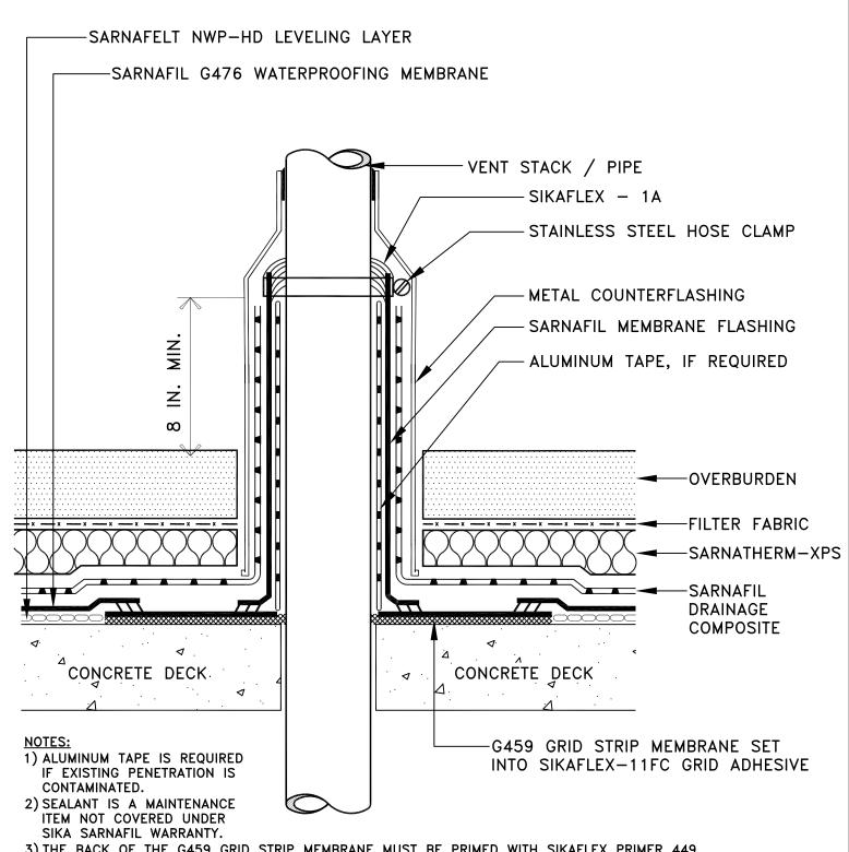
3) THE BACK OF THE G459 GRID STRIP MEMBRANE MUST BE PRIMED WITH SIKAFLEX PRIMER 449.
