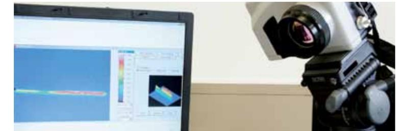
L'ingénierie systèmes de Sika apporte son soutien à l'optimisation de la mise en œuvre des adhésifs en utilisant des méthodes d'essais brevetées. L'illustration ci-dessus montre une caméra à infrarouges mesurant la température de réaction de l'adhésif.
