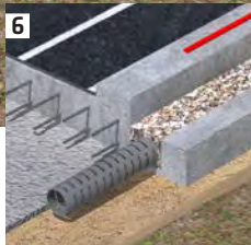
Conduite de drainage
