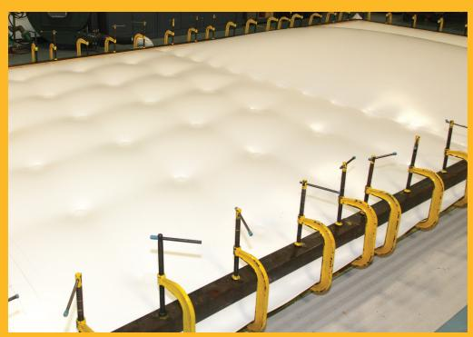
Une membrane PVC en train de subir des essais de résistance au vent. La membrane photographiée a été fixée sur la partie gauche de la surface d'essais avec l'outil RhinoBond ®et à droite avec la méthode conventionnelle de fixation dans le joint.
