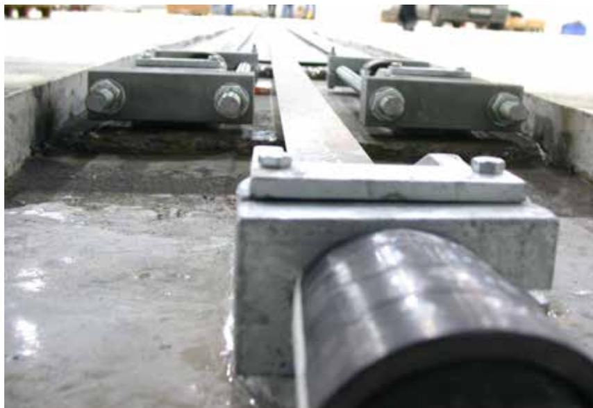
Profilé de base avec des plaques en CFRP précontraintes
