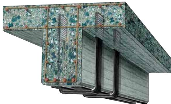
Comme la section d'ancrage d'extrémité du profilé en L Sika CarboShear est préendue chantier, toutes les longueurs de pattes sont possibles. Avec les différentes tailles de profilés en L Sika CarboShear disponibles, il est possible de renforcer les poutres structurales mesurant jusqu'à 140 cm de haut et 140 cm de large.
