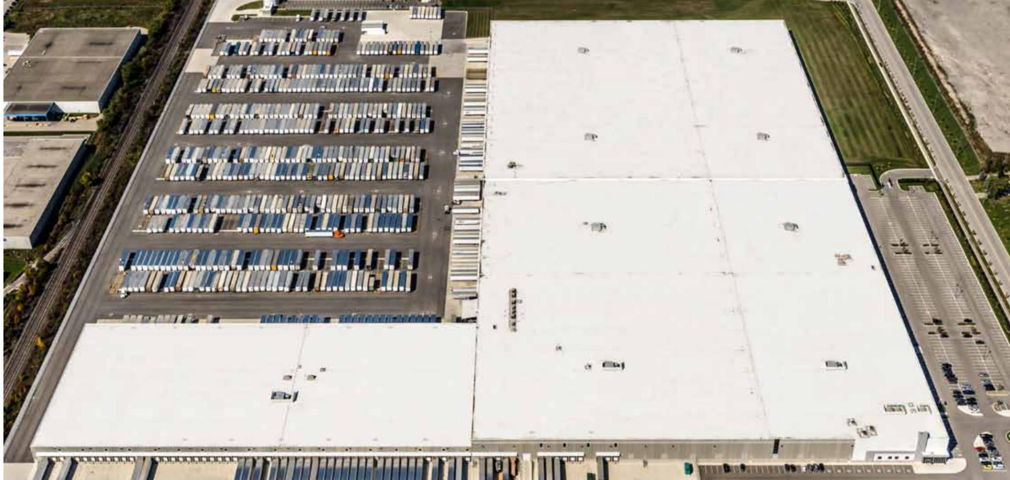
Une membrane réfléchissante Sika Sarnafil a été utilisée pour recouvrir les 1.3 millions de pieds carrés de toiture du centre de distribution de Target situé à Milton en Ontario.
